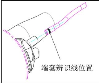
Fig. F-4 外管务必确实安装
